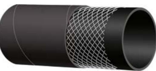
**Fiskepumpeslange 3 bar (45 psi)****Innvendig:** Svart sjøvannbestandig nitrilgummi (NBR).**Armering:** Ett syntetisk tekstilinnlegg.**Utvendig:** Svart ledende sjøvannsbestandig Nitril/PVC gummi (NBR/PVC).**Bruk:** Fiskepumpeslange fleksibel og slitesterk.**Sikkerhetsfaktor:** 3:1**Temperatur:** -30°C +80°C
