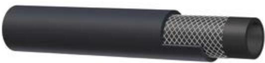
**Trykkluftslange - EPDM****Innvendig:** Svart glatt EPDM-gummi.**Armering:** Ett syntetisk tekstilinnlegg.**Utvendig:** Svart glatt EPDM-gummi.**Bruk:** Slitesterk trykkluft- og vannslange for mekanisk industri samt bygge og anleggsindustrien.**Sikkerhetsfaktor:** 3:1**Temperatur:** -40°C +100°C
