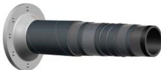
**Slanger med vulkanisert flens til brønnbåter****Innvendig:** Syntetisk gummi.**Armering:** Syntetisk innlegg og stålspiral.**Utvendig:** Syntetisk gummi.**Bruk:** Slange med vulkaniserte DN10 flenser spesielt for vann og fisk på brønnbåter og i fiskemottak etc.**// 101ECO**
